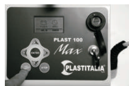
Phase 6 ou réglage manuel des paramètres de soudure
