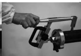
Fase 3: o raspaduras mecánica
