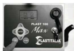
Fase 6 o impostazione dei parametri di saldatura manuale
